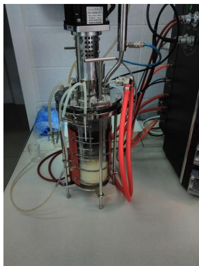
Рис. 1 Проведение гидролиза на ферментаторе
