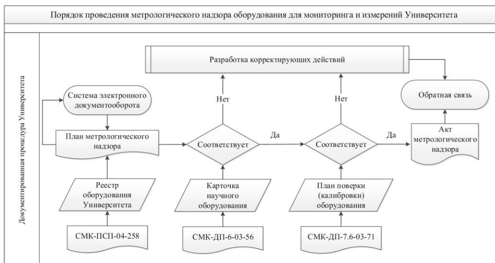
Рис. 1. Схема проведения метрологического надзора оборудования.
