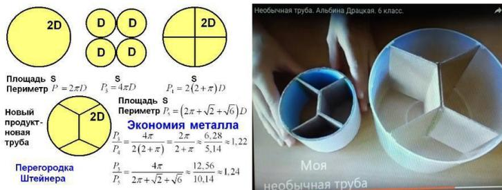
Рис.2. Новая необычная труба с перегородкой Штейнера
