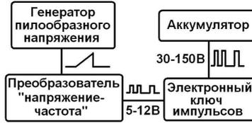
Рис.2. Блок-схема нового десульфатора
