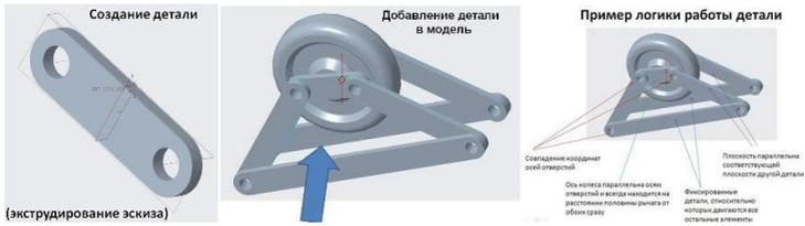
Рис.2. Процесс создания модели в среде Creo parametric 4.0.
