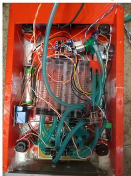
В качестве силового блока используются четыре двигателя постоянного тока с винтами для движения вперед, назад, влево, вправо.
